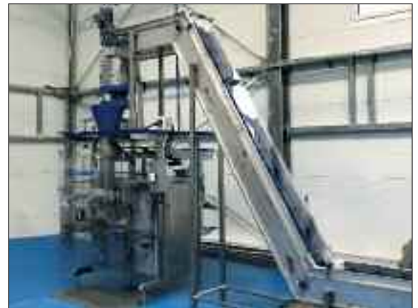
Individuell konzipierte WESSAMAT-Fördertechnik mit automatischer Abfüll- und Verpackungseinheit für Eiswürfel und Crushed-Ice
