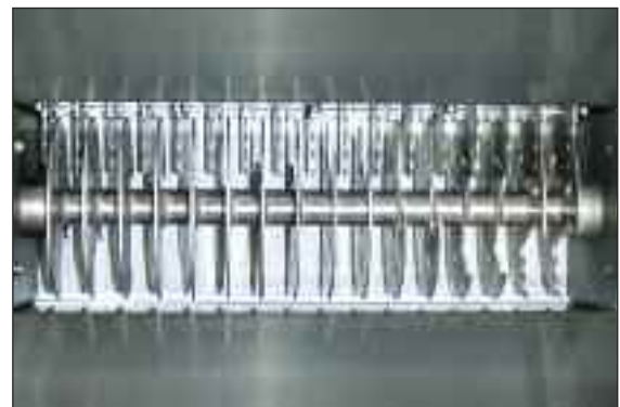
Mahlwerk des Crushermoduls aus solidem Edelstahl.
