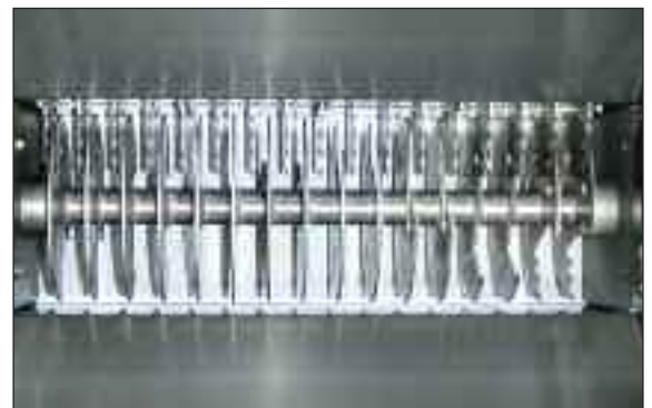
Mahlwerk des Crushermoduls aus solidem Edelstahl.
