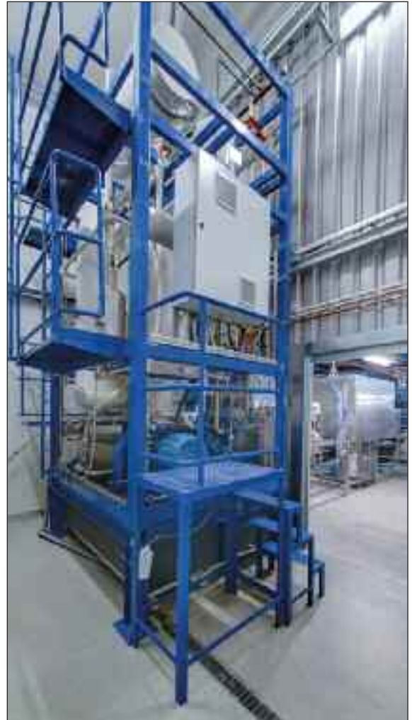
Eisbereitungsanlage PATKOL-WESSAMAT PK 10 AU zur Herstellung von Röhreneis (Tube-Ice)
