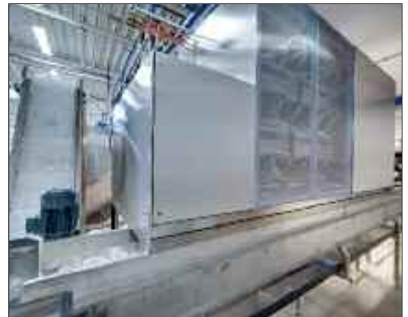
Eisbereitungsanlage IC 1500 auf Eistransportband zur Herstellung von quadratischen Volleiswürfeln
