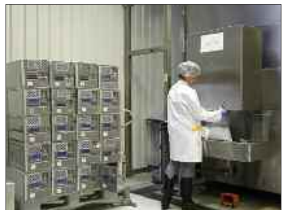
Eisproduktion mit halbautomatischer Abfüllung von Hohleis kegeln für das Inflight-Catering
