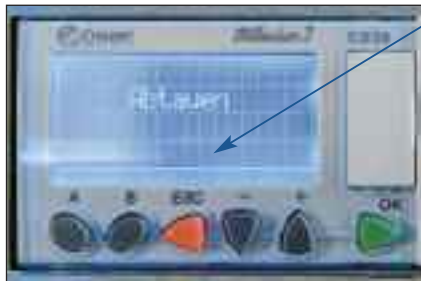
Die aktuellen Betriebszustände werden dem Anwender über das digitale Display in der Frontblende angezeigt
