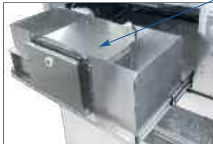
Die ausziehbare Schiebevorrichtung ermöglicht die einfache Reinigung des Crushermoduls
